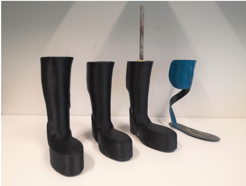
3D-gedruckte Formen, fertige CFRP-Orthese
