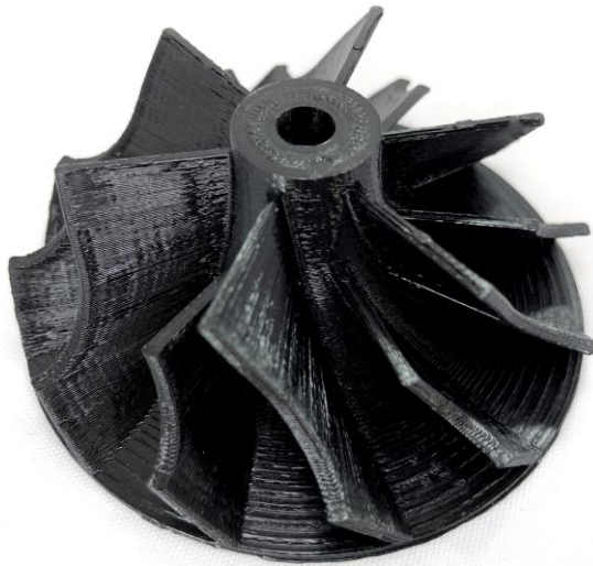
3D-gedrucktes Flügelrad aus LUVOCOM 3F eco PET 50291 BK
