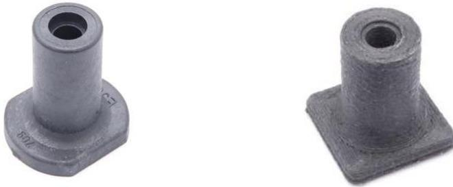
Abb. 4: links: Schraubdom gespritzt; rechts: Schraubdom gedruckt
