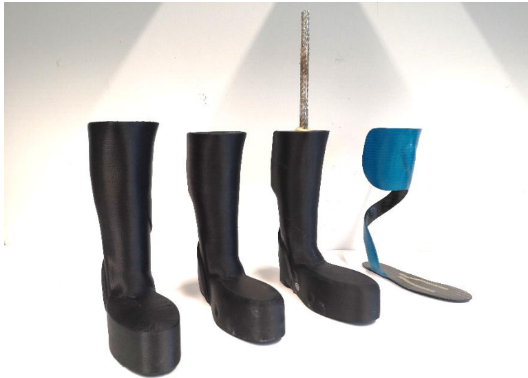
Abbildung 5. 3D-gedruckte Form, Form mit Griff, fertige CFK-Orthese
